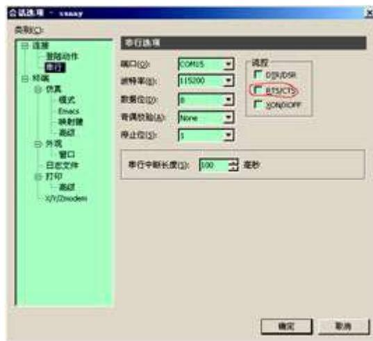
请根据上图配置串口，右侧画红圈部分三个勾都要去掉，全部不选，波特率选择 115200。请在插好 USB 转串口线后，在“我的电脑”图标上按右键，选择“属性”，再选择“硬件”中的“设备管理器”，查询里面的“端口”，即可知道本机使用了哪个端口，请根据自己的电脑配置情况选择端口号（如果为非 XP 系统，就请自行设法找到“设备管理器”）。
