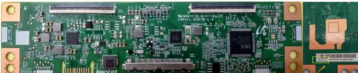
通代操作 2：用彩虹玻璃 CV500U2-T01 代换原玻璃，用驱动板 CV500U2-T01 或 CU580U1-T01 代换原驱动板（不需更改屏参），装机后开机测试，电视画面正常。
