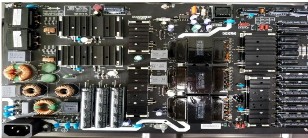
图1 创维N030102-000664-102电源板实物图
