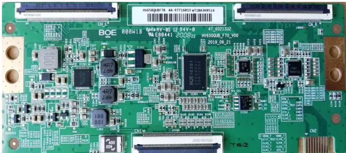
**通代操作 2：**用京东方玻璃 HV650QUB-F90 代换原玻璃，用配套的驱动板（如下图）代换原驱动板，用配套的 FFC 线代换原 FFC 线。装机，开机测试，电视画面正常。
